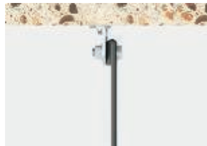
Вид натоварване 3: Завинтена към плосък окачвач, край на лентата е двоен, свободният край на лентата е отвътре Минимален разрушаващ товар съгласно колона А
