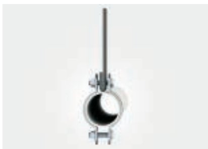
Вид натоварване 10: Краят на лентата е за- винтен към скоба за тръба, краят на лентата е сдвоен Минимален разрушаващ товар съгласно ко- лона А
