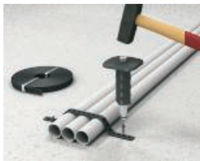
Приложение дюбел "ОБО" тип 903/RB с монтажна лента Дюбели "ОБО" без резба като 903/RB са подходящи за закрепването на монтажни ленти например върху суров бетон.
