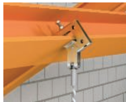
Приложение на трегер-клема с шарнир Използват се за окачване към коси стоманени конструкции. Закрепването се осъществява чрез винтовото затягане.
