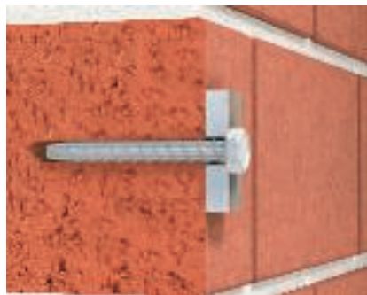
Противопожарни винтови анкери MMS За приложението на винтов анкер не са необходими пластмасови дюбели. Винтовият анкер се завинтва директно в почистения отвор.
