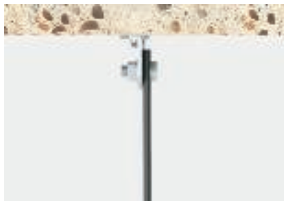
Вид натоварване 2: Завинтена към плосък окачвач Минимален разрушаващ товар съгласно колона В
