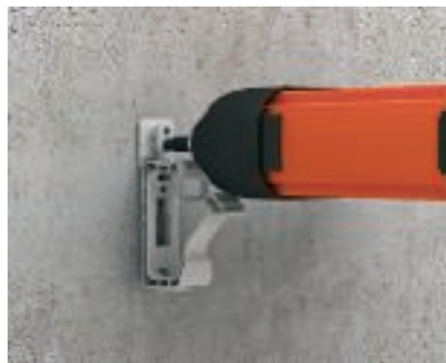
Монтаж на стената с пистолет Крепежният елемент на събирателната скоба може да се надене на главата на пневматичен чук и автоматично да се зафиксира с помощта на специални пластини. Закрепването се изпълнява без други спомагателни средства с помощта на пневматичния чук към стената или тавана.
