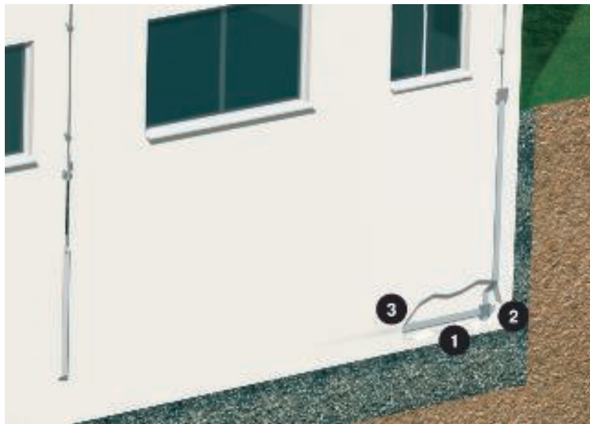
1 = плосък проводник, 2 = диагонални клеми, 3 = дистанционер
