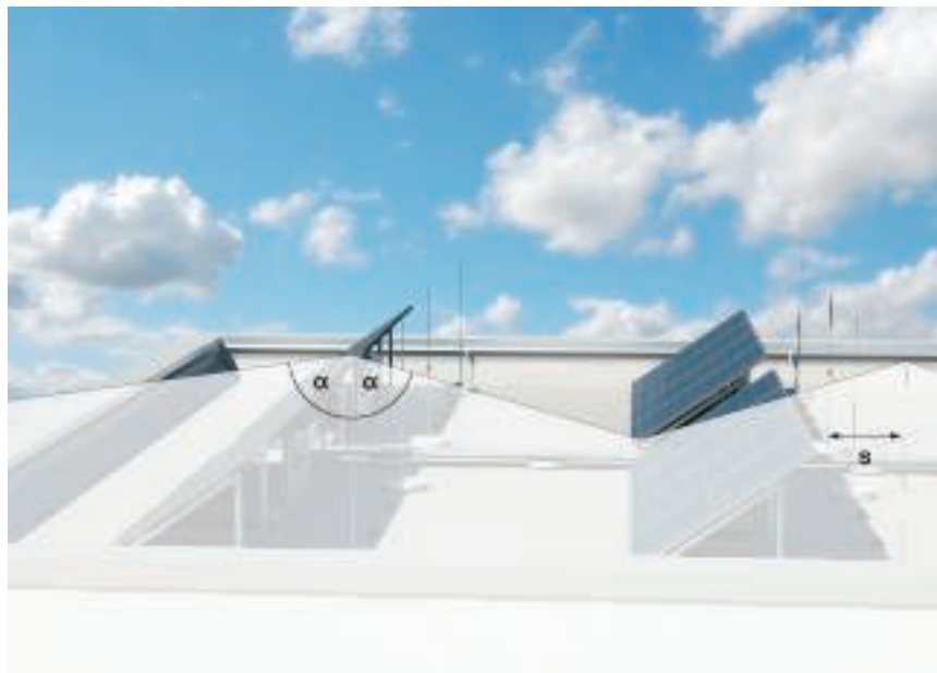
Фиг 2: \alpha^\circ = защитен ъгъл
