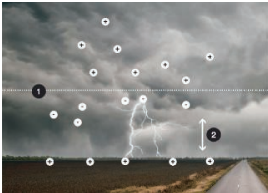
Разпределение на заряда: 1 = около 6.000\text{ m} , 2 = електрическо поле
