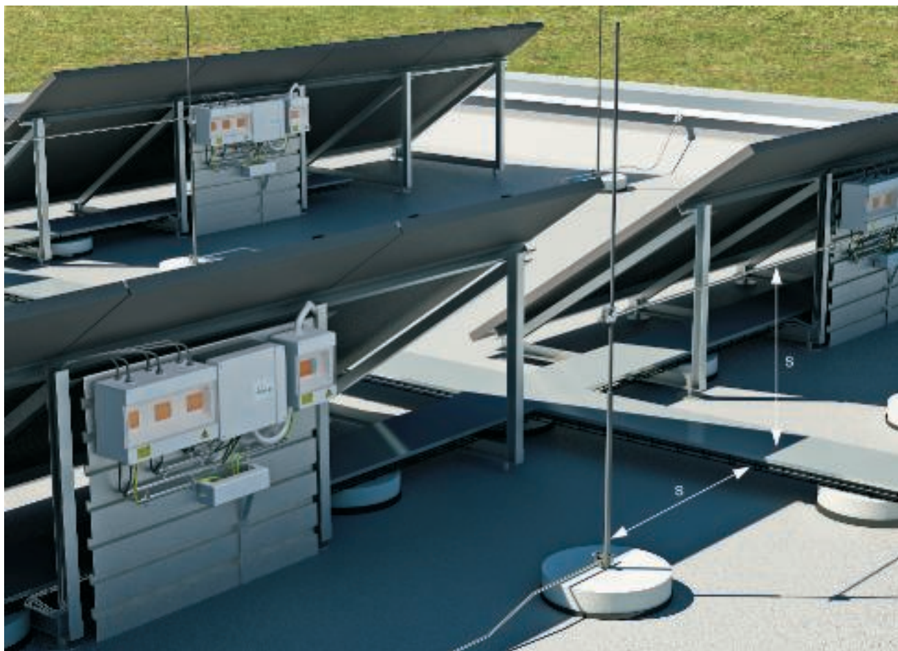
Фиг 5: Разделителна дистанция ( s ) между кабелен канал и мълниеуловително устройство
