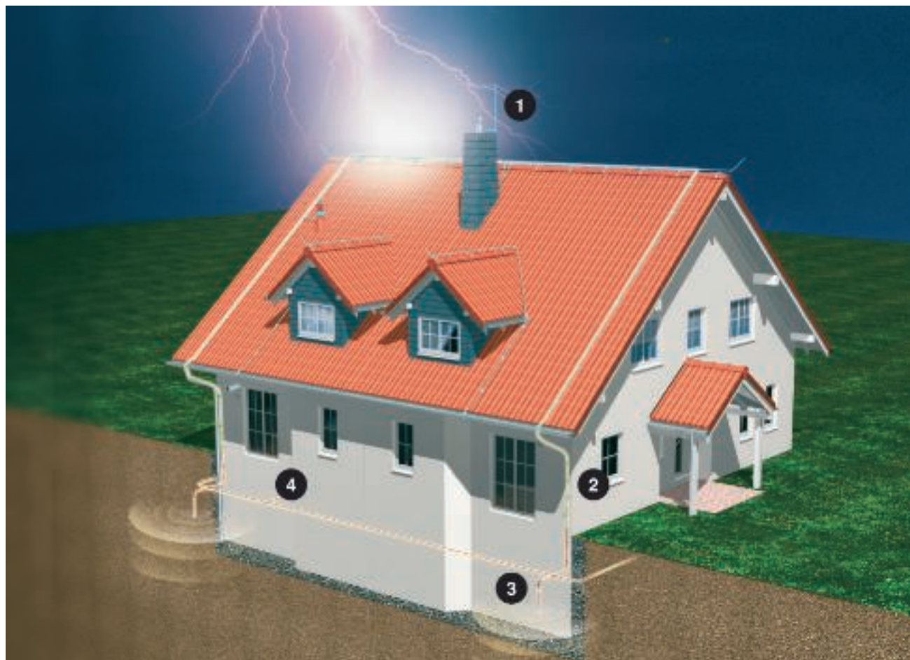
1 = мълниеприемник, 2 = токо отвод, 3 = заземляващо устройство, 4 = изравняване на потенциала
