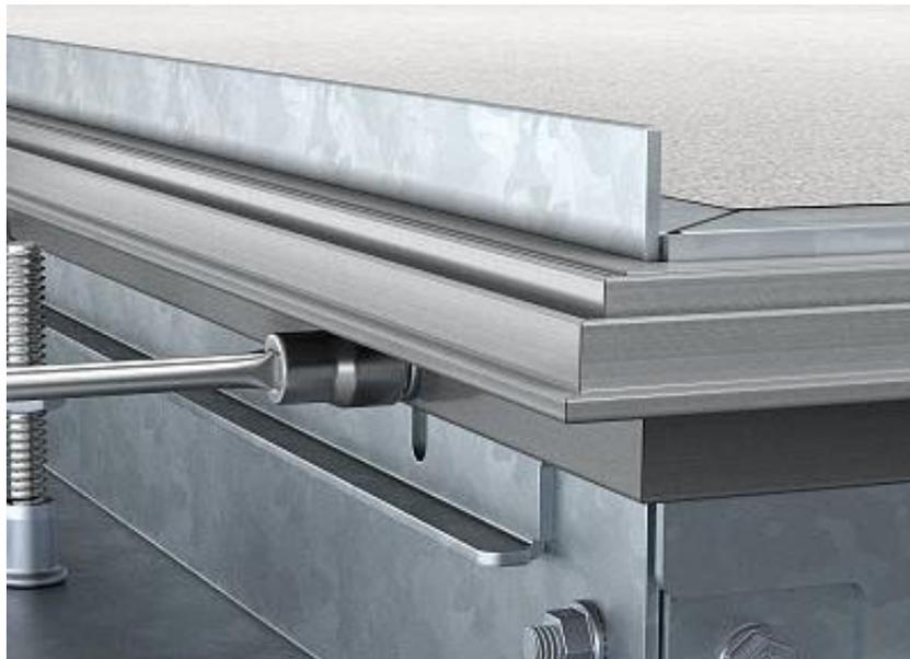
Nach dem Aushärten des Estrichs kann der Kanal mit Bodenbelag belegt werden. Die Bodenbelaganlegekante des Kanals in Richtung Raumseite, wird auf die Oberkante des Fertigfußbodens eingestellt. Einstellbereich 0 – 25 mm.
