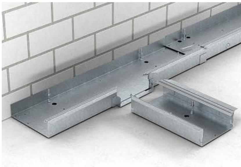
Sollte der **OKB-U..ON** Kanal mit dem Einspeisekanal **OKB-E..ON** verbunden werden, müssen T-Stücke an vorgesehenen Stellen im Kanalverlauf eingebaut und befestigt werden. Benötigte Systemhöhe einstellen und durch Kontermutter sichern.
