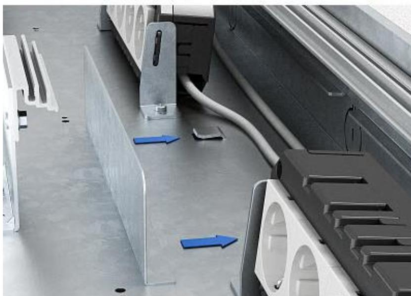
Die Trennstege werden erst nach Montage der fertig verdrahteten Gerätebecher und Modulträger in die entsprechenden Befestigungslaschen in der Bodenwanne eingesetzt.
